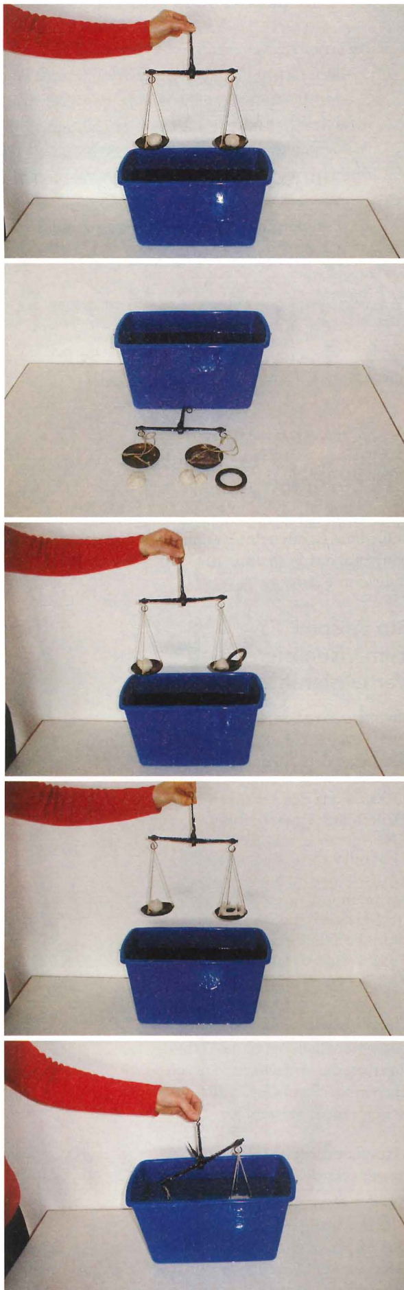
Abbildungen 3a–3e: Das Auftriebsexperiment als Realexperiment nach Archimedes
